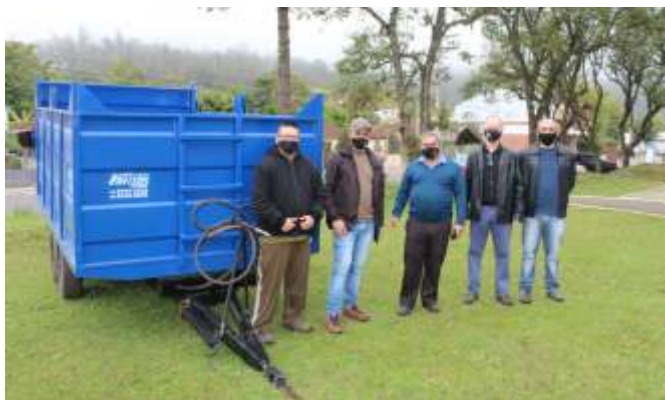
Caçamba agrícola hidráulica de metal com capacidade para 5 toneladas
